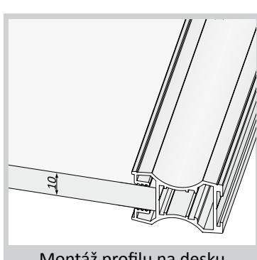
K montáži profilu nepoužívejte montážní lepidlo.
